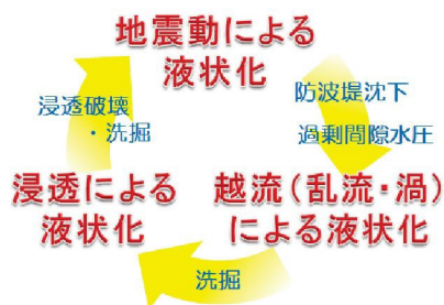
図-5 地震・津波による地盤液状化 (流動化) を伴う混成堤の被害ループ
